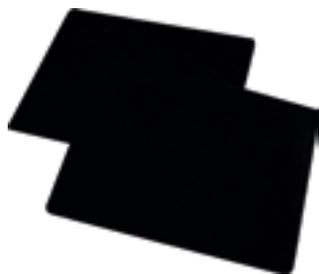
Высокоэффективный угольный фильтр длительного использования изготавливается из двух слоев сетчатого пенополиуретана и содержит гранулы активированного угля. Эффективность очистки от запахов составляет — 80%. После 3–4 месяцев использования может быть восстановлен при помощи мытья в посудомоечной машине. После 10 циклов очистки подлежит замене.
