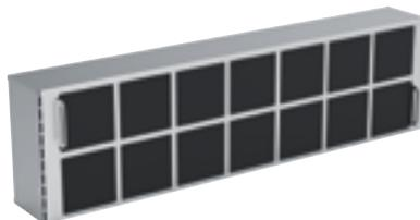
Высокоэффективный керамический угольный фильтр длительного использования, корпус изготовлен из керамики с напылением. Эффективность очистки запахов составляет — 90%. После 3–4 месяцев использования может быть регенерирован в духовке при температуре 250С в течение 1 часа. После 30 месяцев использования подлежит замене.
