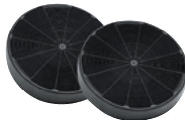
Угольный фильтр длительного использования изготовлен из одного слоя сетчатого пенополиуретана, содержит гранулы активированного угля. Эффективность очистки запахов составляет — 66%. После 3–4 месяцев использования может быть восстановлен при помощи мытья в посудомоечной машине. После 8 циклов очистки подлежит замене.
